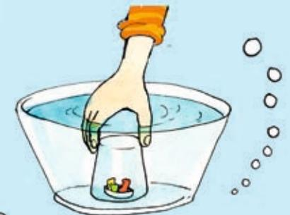
Wie bei einer richtigen Taucherglocke bleiben die Bärchen dabei vollkommen trocken. Im Glas befindet sich Luft. Diese sorgt dafür, dass an diesen Platz im Glas kein Wasser eindringen kann.
